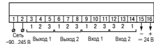
Рисунок 10 – Назначение контактов клеммной колодки прибора в настенном Н и щитовом Щ1, Щ2 типах корпусов
