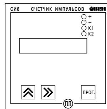
Рисунок 18 – Лицевая панель прибора для корпусов настенного (Н) и щитового (Щ1) креплений
