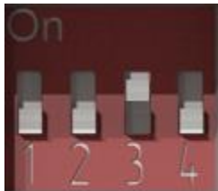
Рисунок 9.64 – DIP-переключатель. Джампер 3 в положении ON
