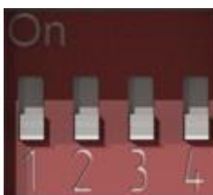
Рисунок 6.6 – DIP-переключатель. Джампер 2 в положении OFF
