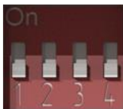
Рисунок 6.13 – DIP-переключатель. Джампер 2 в положении OFF
