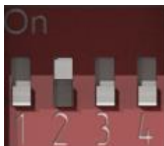
Рисунок 6.12 – DIP-переключатель. Джампер 2 в положении ON
