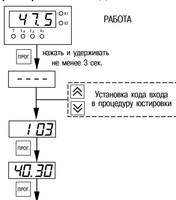
Рисунок 8.4 – Последовательность работы при юстировке
