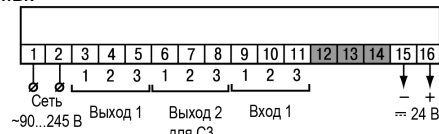
Рисунок 10 – Назначение контактов клеммной колодки прибора в настенном Н и щитовом Щ1, Щ2 типах корпусов
