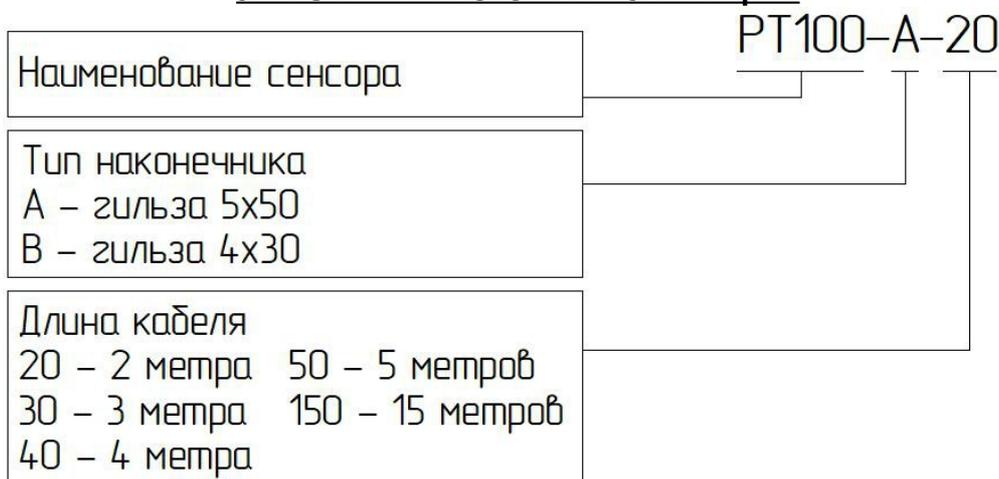
Рис 1 — Пример обозначения датчика
