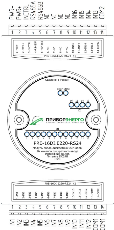
Рис. П1.1. Внешний вид и схема подключения модуля PRE-16DI.XXX-RSX
