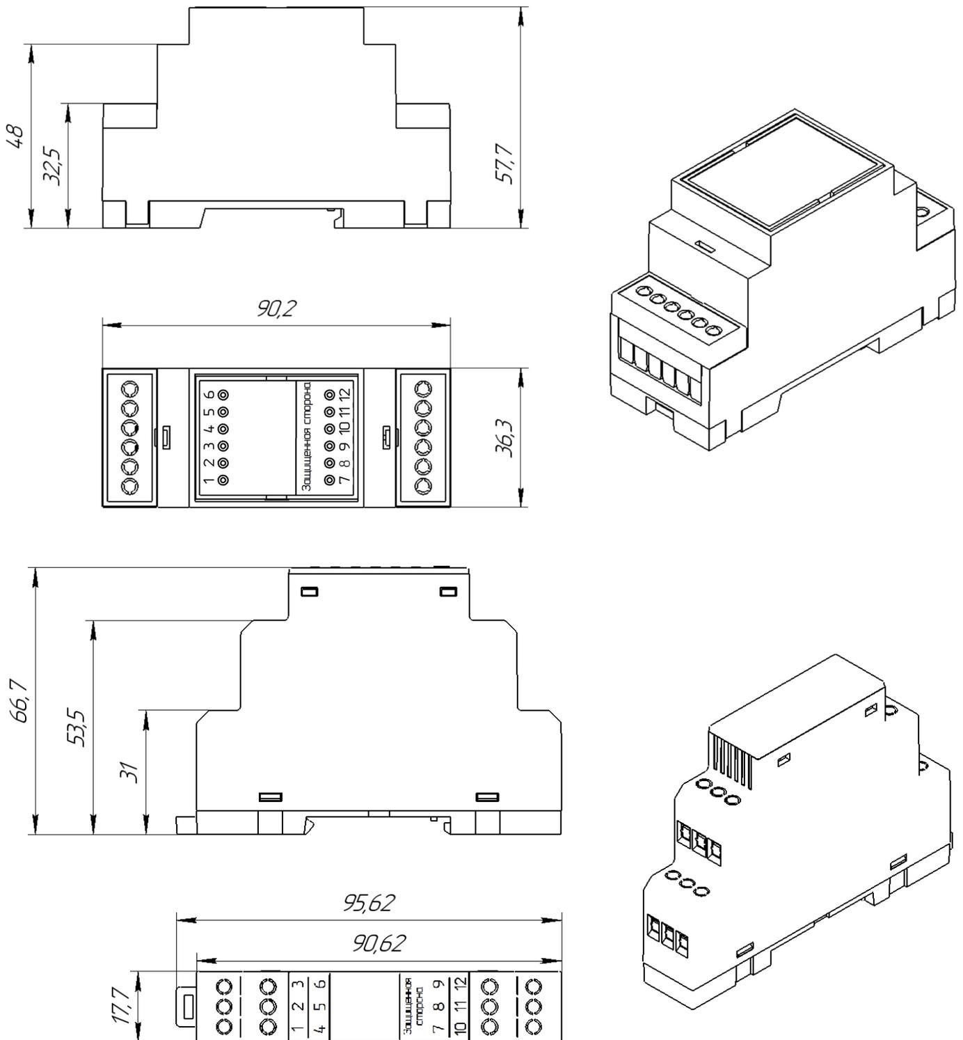
Рис. 2. Установочные размеры
