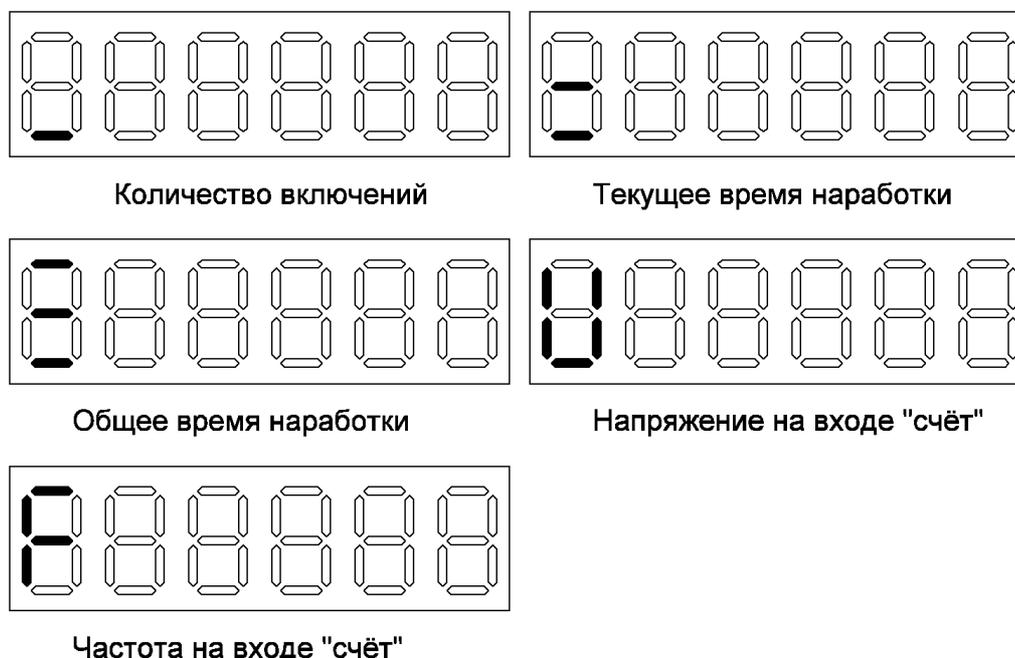
**Рис.3 Режимы индикации моточасов WTM-01**
