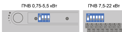
Рисунок 6.4 – Вид на блок DIP-переключателей
