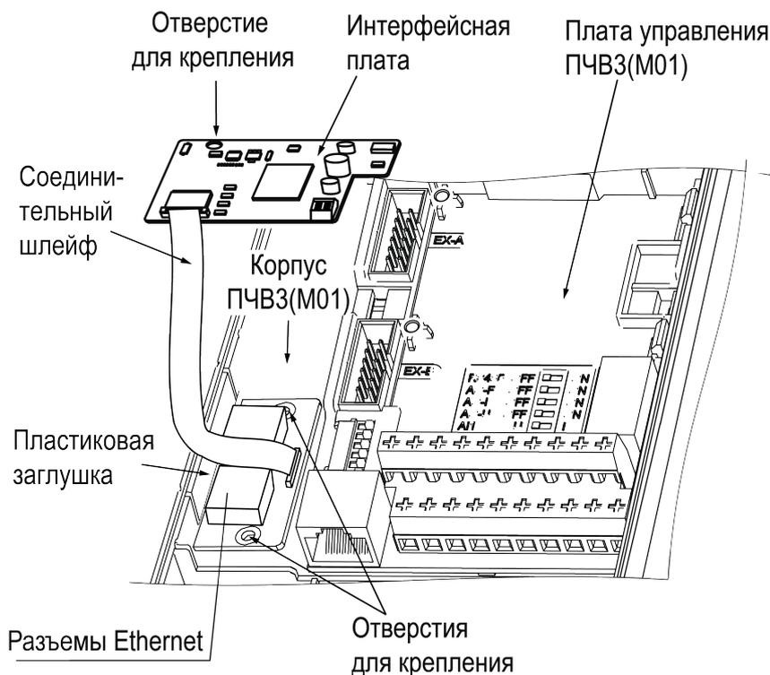
Рисунок 3.2 – Монтаж платы на преобразователях частоты мощностью 5,5 – 45 кВт
