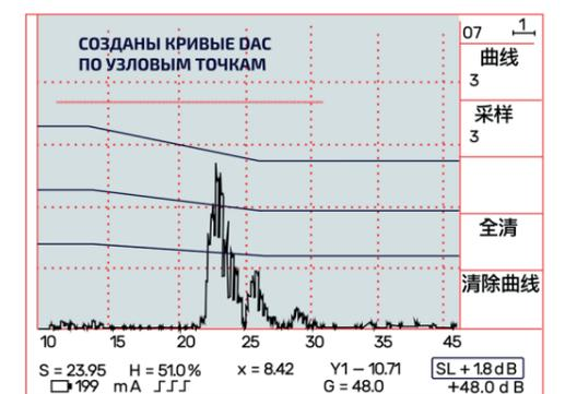
Рис. 37 Созданы кривые DAC по узловым точкам
