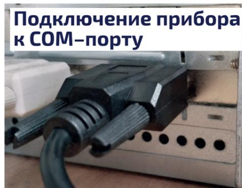
Рис. 57 Подключения прибора к COM-порту
