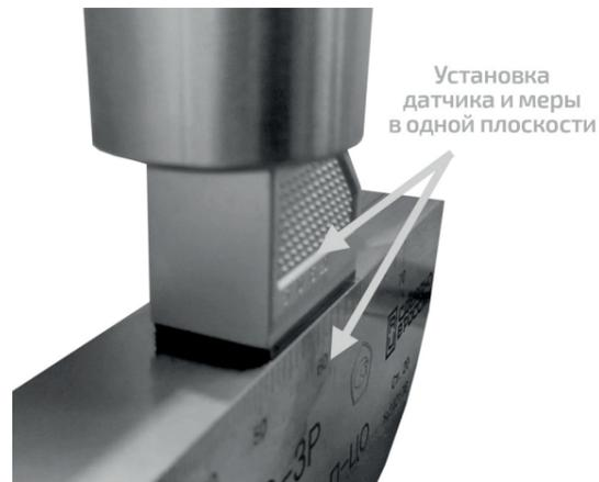
Рис. 14. Установка датчика
