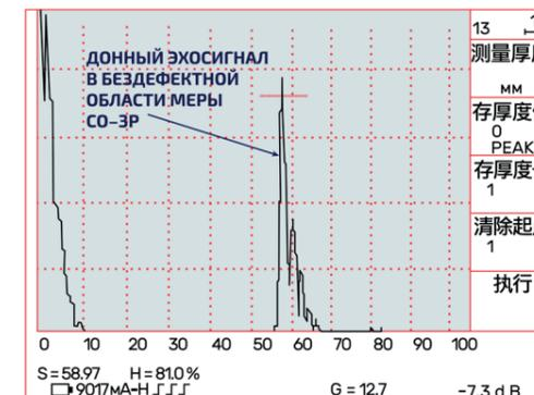
Рис. 27 Измерение толщины
