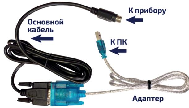
Рис. 59 Соединение основного кабеля и адаптера
