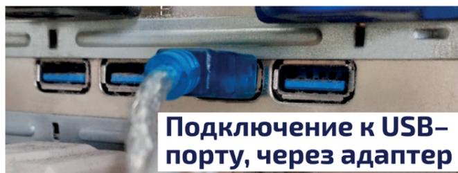
Рис. 60 Подключение адаптера к USB-порту
