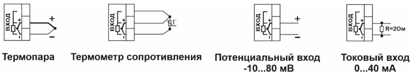
Рисунок 3 – Схемы подключения датчиков температуры
