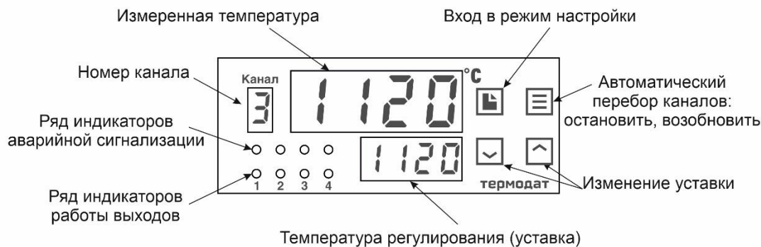
Рисунок 4 – Описание индикаторов и кнопок управления прибора Термодат-13К6-Р6..
