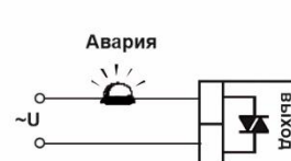
Подключение аварийной сигнализации
