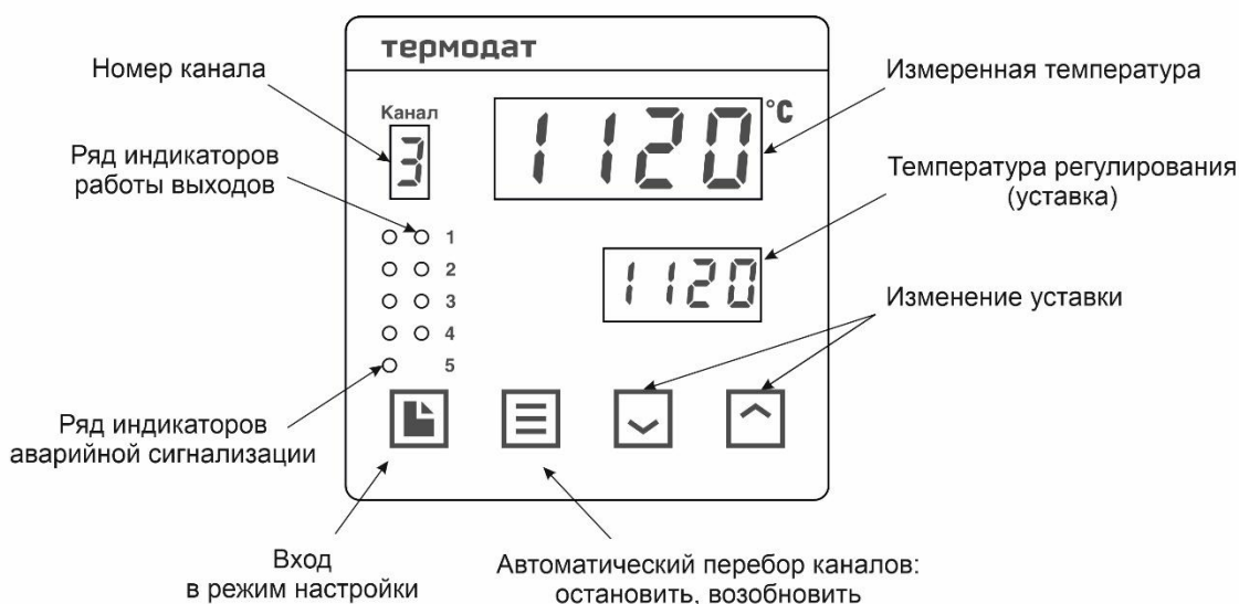
Рисунок 3 – Описание индикаторов и кнопок управления прибора Термодат-13К6/...
