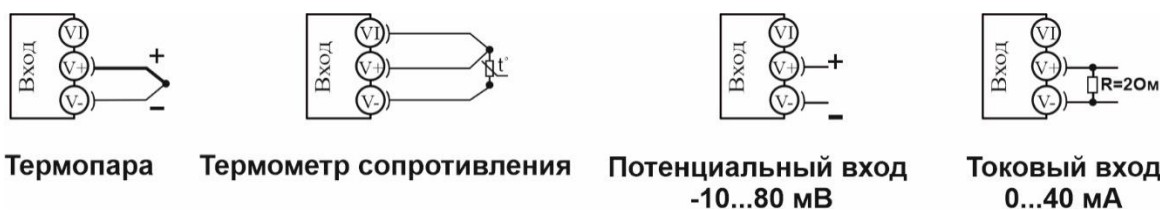
Рисунок 5 – Схемы подключения датчиков
